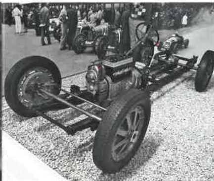
Šasi brněnského vozu Z-14 (1931) s přeplňovaným osmipístovým čtyřválcem 1,5 litru s konstrukcí podvozku inspirovanou Bugattí. NTM vlastní jediný ze tří či čtyř vyrobených podvozků. Závodily na Grand Prix v Brně 1934, 1935 a 1937, z nichž nejlepší dojel šestý ve třídě (1934)
