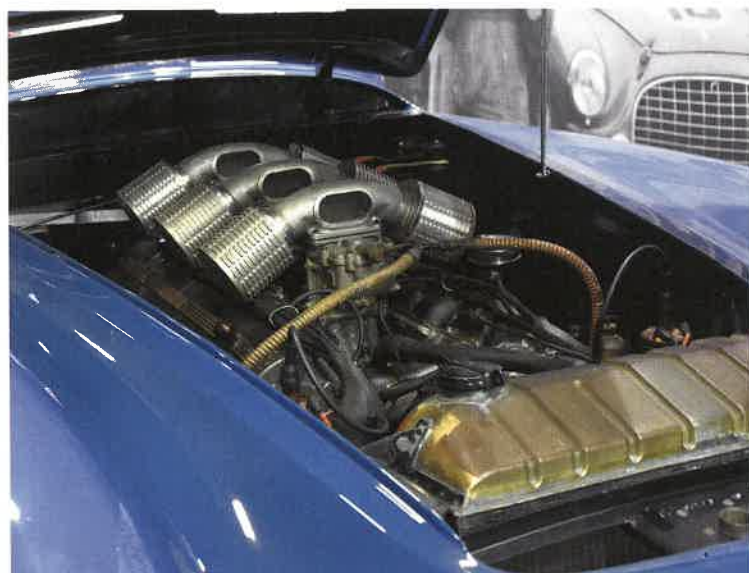
Ferrari 340 America Barchetta Touring Superleggera na veľtrhu odhalovalo motor SOHC s objemom zvýšeným na 4 102 cm 3 (220 k/161,7 kW). V spolupráci s 5-stupňovou prevodovkou Ferrari zvládlo rýchlosť viac ako 240 km/h.
