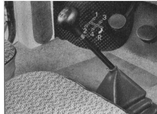
Bild 19. Schaltung und Schaltschema
