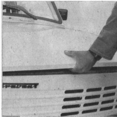
Bild 10. Entriegeln des Sicherungshebels
