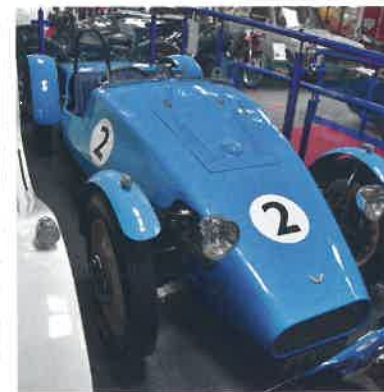
TVR (1952) – druhé vyrobené a nejstarší přeživší TVR. Roadster má ještě kovovou karosérii navrženou Les Dalem a motor Ford SV, ale vylepšenou přední nápravu s lichoběžníky a příčnými listovými pery
