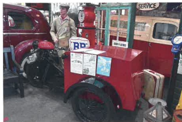
Ze všech stran tísňená rozvázková tříkolka Turner Tri-van (1949), jediná, která přežila. Výrobce traktorů a čerpadel vyráběl tyto bizarní tříkolky s dvoudobým motorem 168 cm 3 a třístupňovou převodovkou nad předním kolem a benzinovou nádrží na řídicích. Podobnou konstrukci měly menší dvoukolové By-vany
