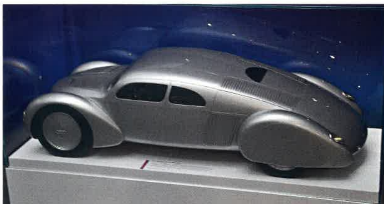
Model aerodynamické karosérie velké limuzíny (1934) Paula Jaraye. Při pozorném pohledu si všimneme, že řadu prvků později převzala Tatra 77
