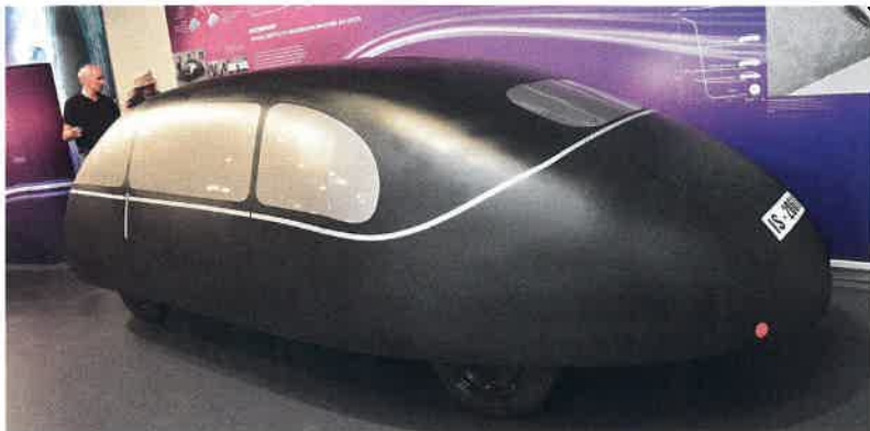
Replika vozu Schörwagen ve skutečné velikosti, který stavěli v letech 1937–1939 na výzkumném pracovišti aerodynamiky (AVA) v Göttingenu. Poháněl jej řadový čtyřválec Mercedes-Benz 1,7 litru (38 k), dosahoval rychlosti až 132 km/h, kdežto v sériovém Mercedesu jen 105 km/h, navíc při asi 30% úspoře paliva
