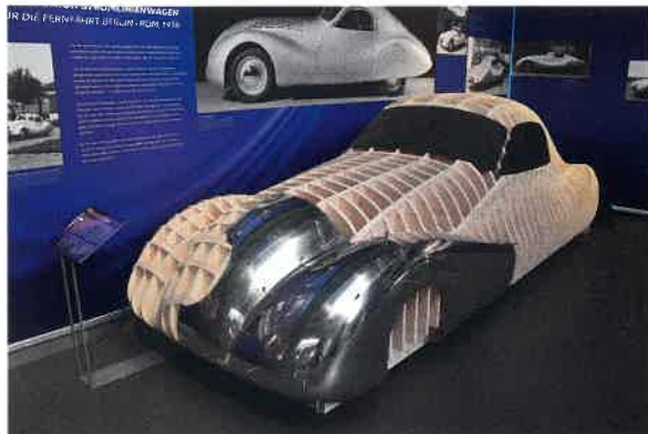
Ukázka stavby aerodynamické hliníkové karosérie vozu DKW F 8 Stromlinie pro propagační jízdu Berlín–Řím 1938. Tehdy na trať vyrazily aerodynamické DKW F 8, Wanderer Typ W23 a Audi Typ 920
